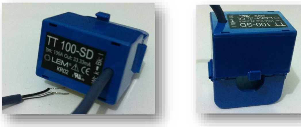
Figura No. 28: Sensor de corriente vista frontal núcleo abierto.
