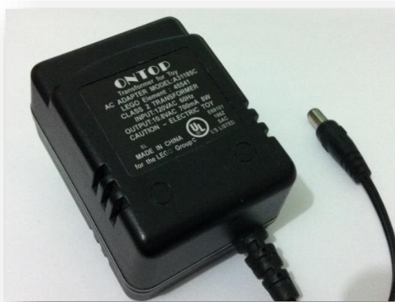
Figura No. 24: Parte frontal sensor - Transformador de voltaje.
