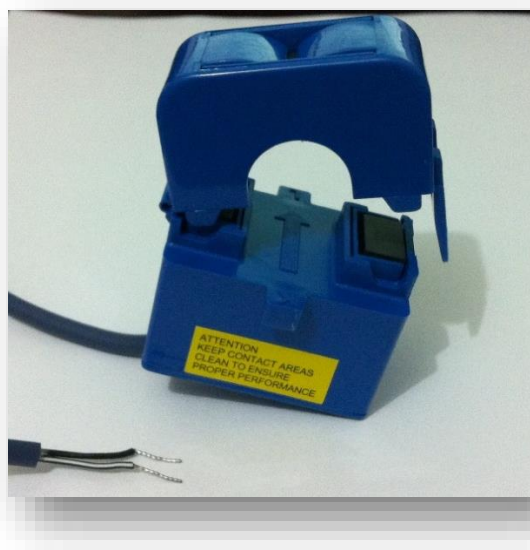
Figura No. 28: Sensor de corriente vista frontal núcleo abierto.
