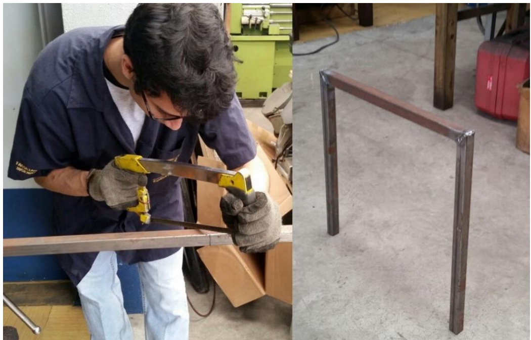
FIGURA 68. PROCESO DE CORTE Y UNIÓN DEL TUBO ESTRUCTURAL.
