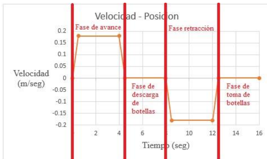
FIGURA 20. FASES DEL CICLO DEL MECANISMO DE MANIPULACIÓN.
