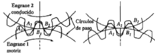
FIGURA 114. TANGENCIA DE LOS CÍRCULOS DE PASO DE ENGRANAJES
