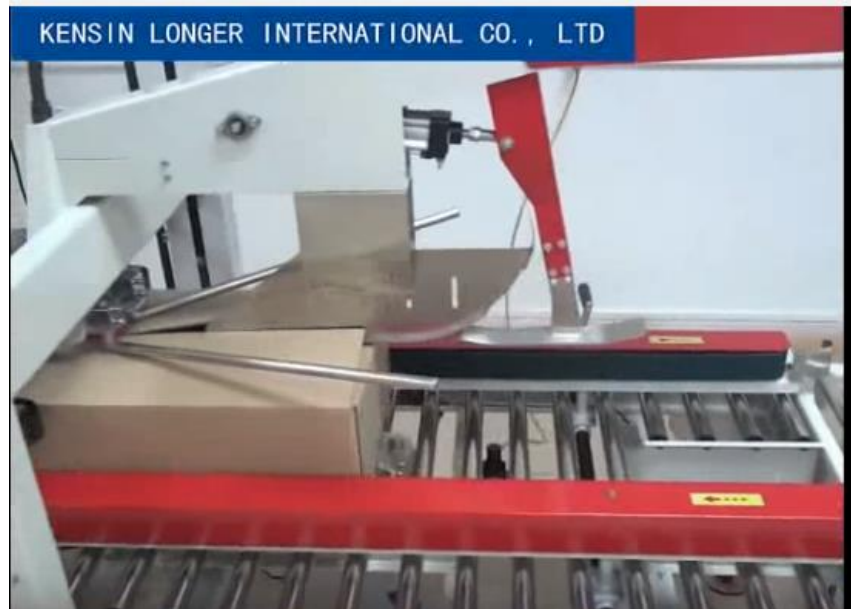
FIGURA 79. MÁQUINA PARA CIERRE DE PALETAS SUPERIORES DE KLONGER
