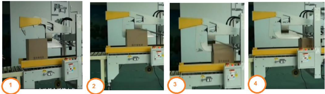
FIGURA 78. PROCESO DE CIERRE DE PALETAS SUPERIORES
