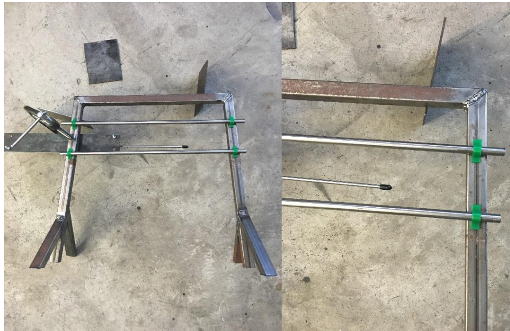
FIGURA 70. PROCESO DE UNIÓN DE LOS EJES GUÍAS Y DEL CILINDRO AL MARCO.
