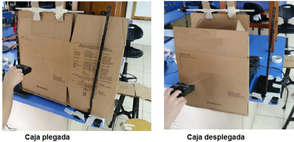
FIGURA 92. EXPERIMENTO PARA FUERZA DE DESPLIEGUE DE CAJAS
