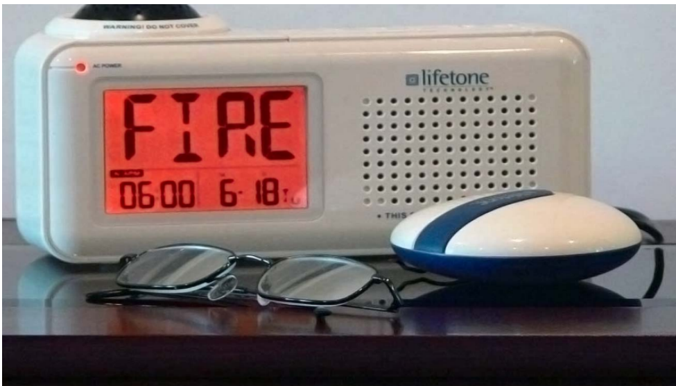
Figura 10: Alarma contra incendios visual y sonora [5]
