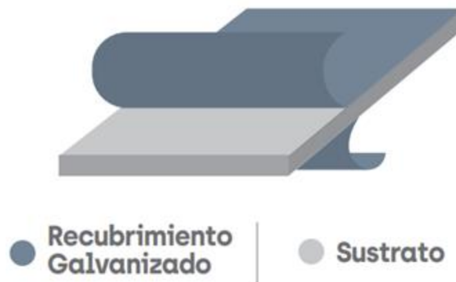
Figura 9: Recubrimiento de Zinc en acero galvanizado
