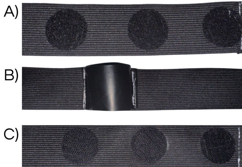
Figura 12: Costuras realizadas para la banda de esfuerzo respiratorio. A) Extremo con velcro suave, en tres puntos para ajuste. B) Velostat cosido a la banda con un poco de holgura para que estire. C) Extremo con velcro áspero para unirlo al velcro suave del A), en tres puntos de ajuste.
