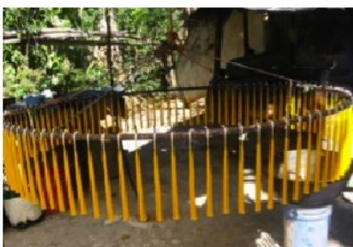
Terminadas. Una vez que han llegado al grosor requerido, se dejan endurecer en el aro.
