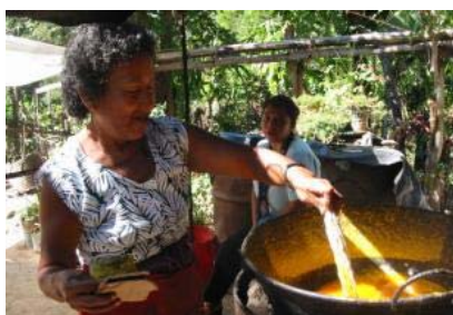
Figura No. 26: Mojar las mechas. Hay que humedecer las mechas con parafina
