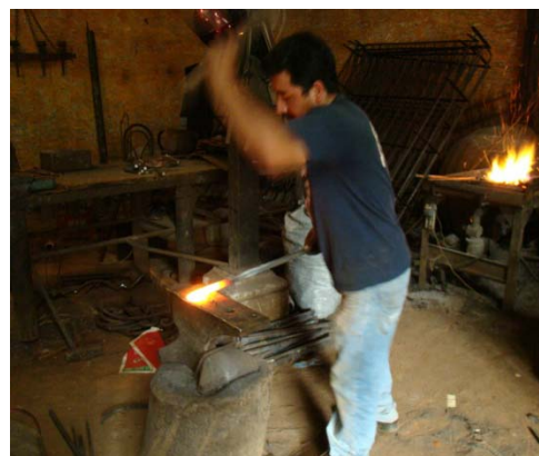
Figura No. 7: Al hierro caliente se le da forma golpeándolo con un martillo, sobre el yunque
