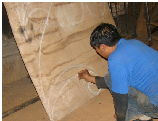
Figura No. 5: El bosquejo es una guía para el forjador
