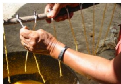
Colgar las mechas. Inmediatamente, se cuelgan las mechas, pasándolas por entre los dedos para que queden rígidas
