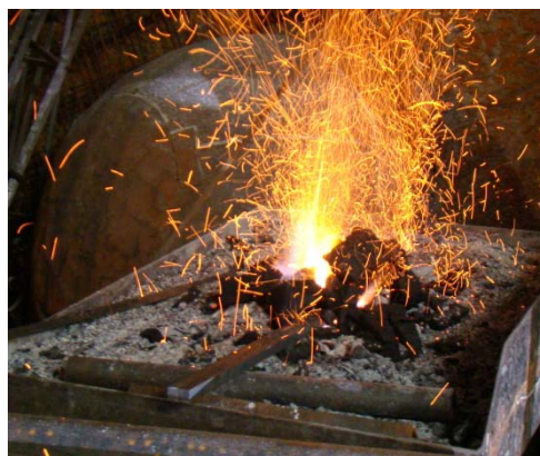
Figura No. 6: El hierro es calentado para volverlo maleable
