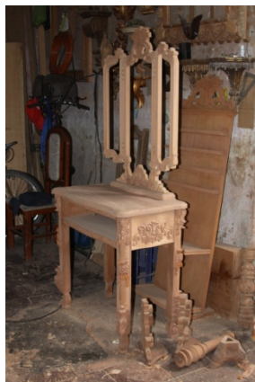
Figura No. 12: Tocador de cedro en proceso de acabado
