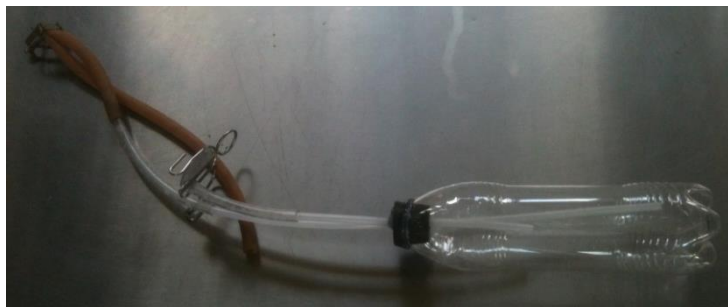
Figura 115. Sistema original de captura de gases de combustión.
