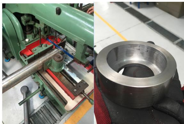
Figura 152. Izquierda: Proceso de corte del material para tambor. Derecha: material del tambor luego de realizar un taladrado y un vaciado en el interior.
