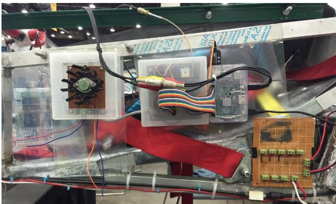
Figura 132. Módulo de sensores fase I instalado en el automóvil.
