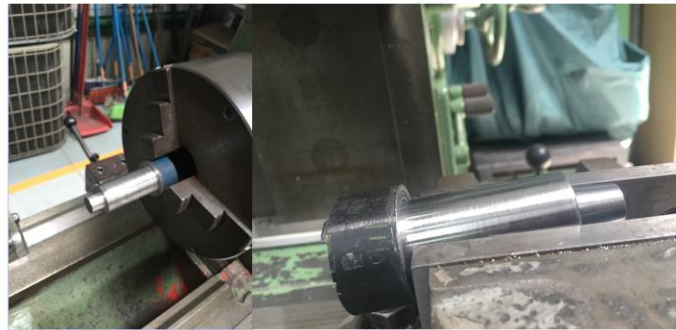
Figura 154. Izquierda: desbastado para obtener la cabeza cónica. Derecha: proceso de manufactura de cuña.
