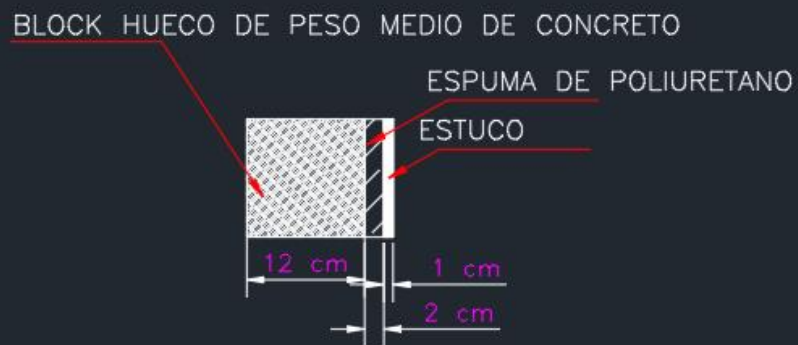
Figura 77: Detalle de vista lateral del muro de blocks huecos de peso medio de concreto donde se indica como va colocada la espuma de poliuretano
