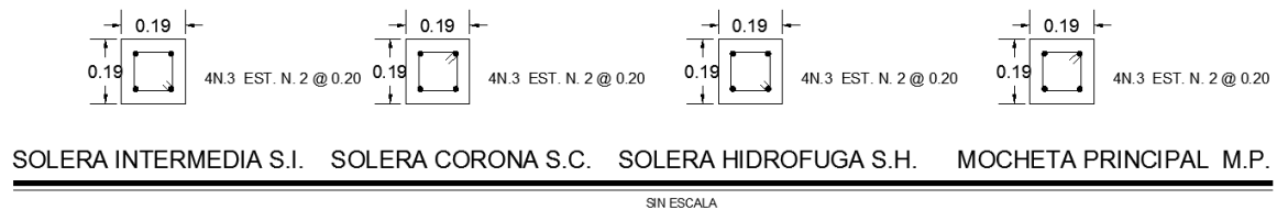
Figura 56: Detalles de elementos de confinamiento vertical y horizontal según AGIES NSE 7.4.
