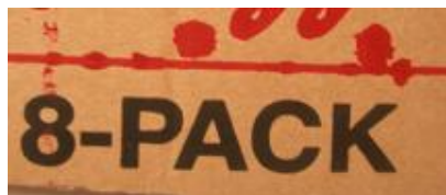
Figura # 16: Manchas en corrugado
