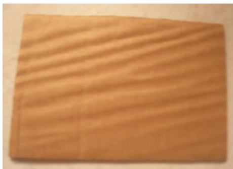
Figura # 17: Problema con el troquelado
