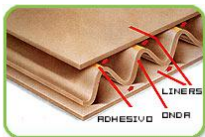
Figura # 4: Componentes de un cartón corrugado
