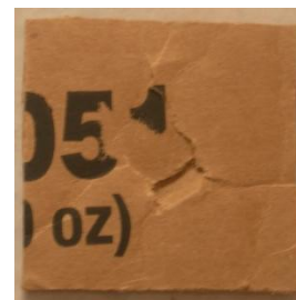
Figura # 18: Hoyo en corrugado
