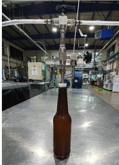
Figura 15. Montaje de pistola llenadora de cerveza
