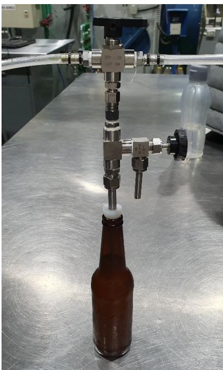
Figura 41. Montaje del sistema de embotellado
