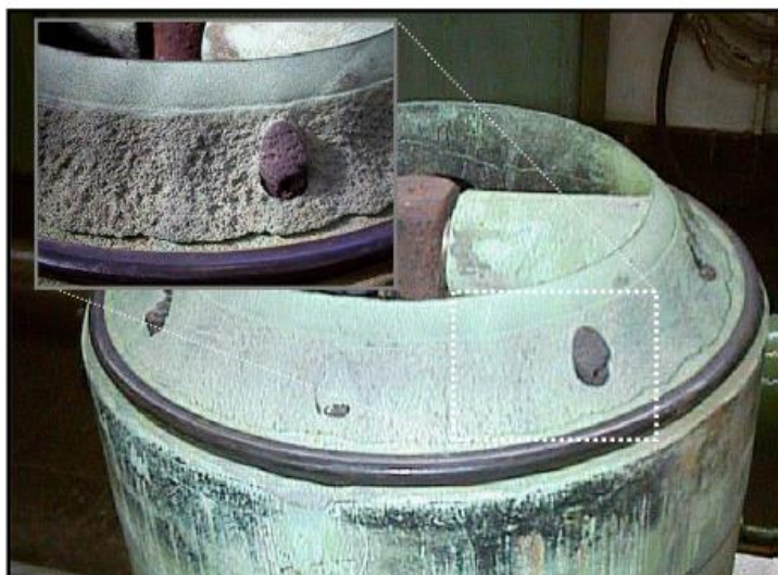
Gráfico 3.1 Desgaste por cavitación en pistón de una válvula de paso anular.
