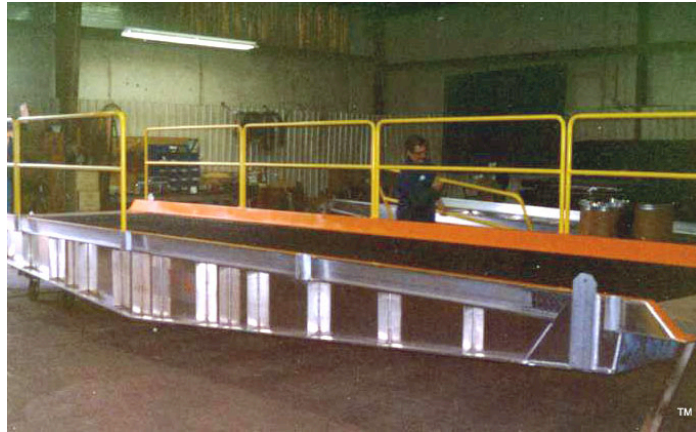
Figura 98: Puente Portátil en Construcción
