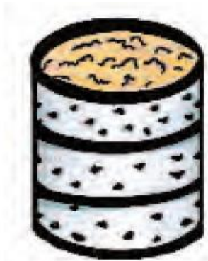
Tacho de 200 litros sin tapa ni fondo con agujeros en toda la superficie
