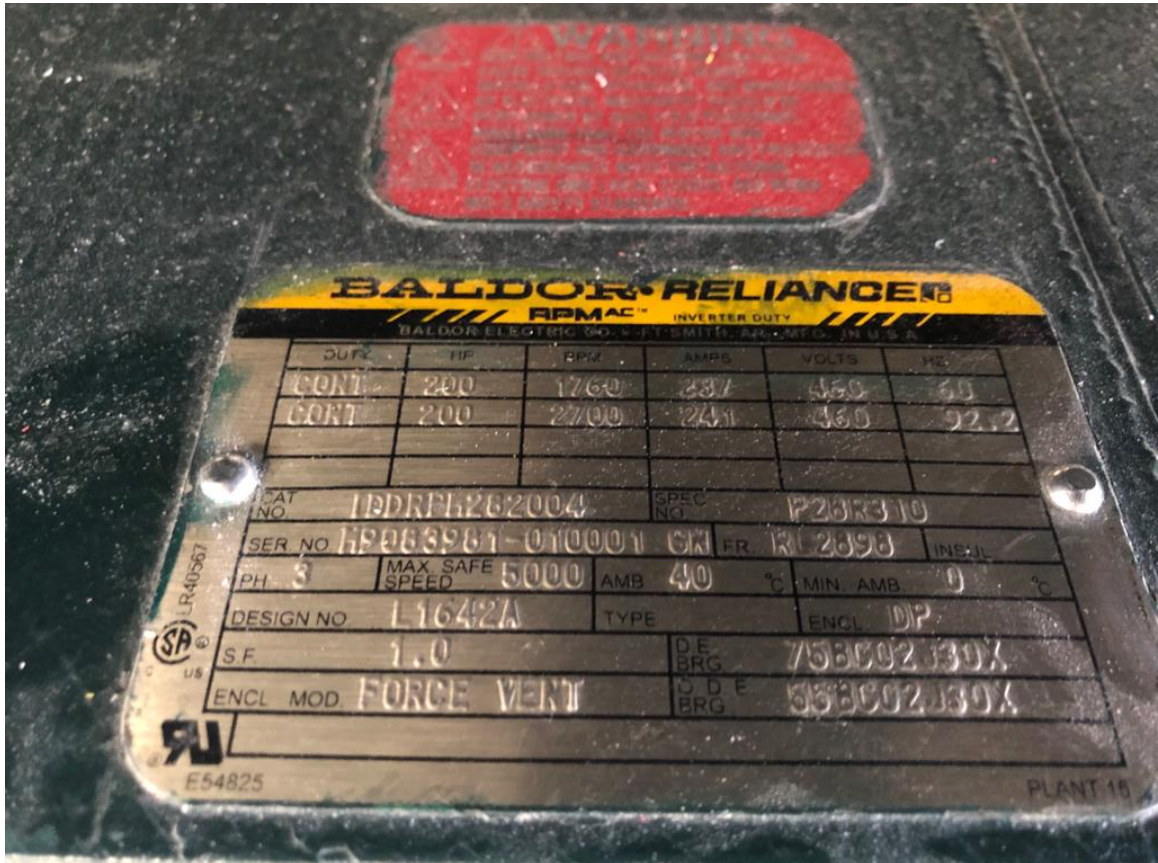
Figura 24. Datos de placa del motor de la extrusora Starex 8
