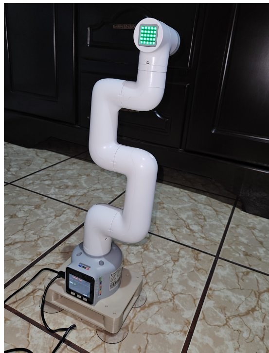
Figura 40: myCobot 280 M5 en su posición inicial
