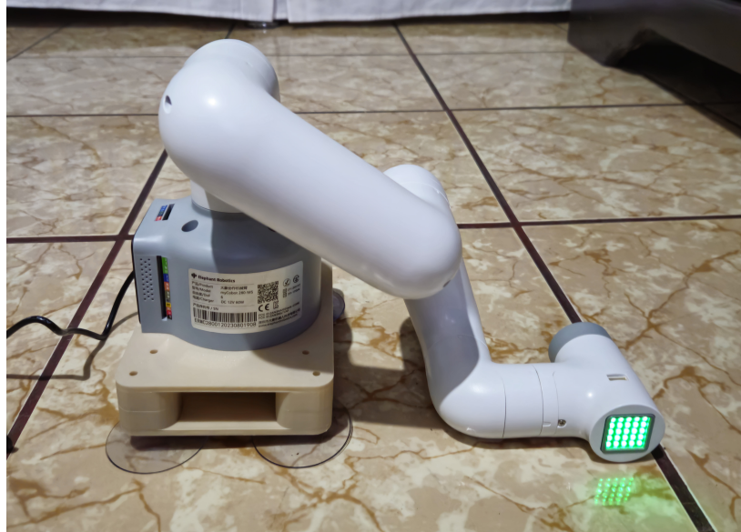
Figura 39: myCobot 280 M5 sin configuración en sus juntas al momento de inicializarse
