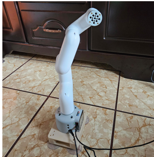
(c) myCobot 280 M5 con configuración de ángulos
