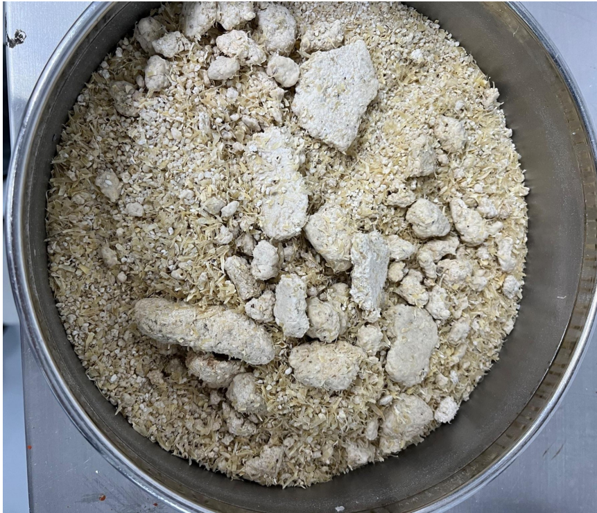
Figura 50. Evidencia fotográfica del tamizado mesh No. 30 (laboratorio de operaciones unitarias, Universidad del Valle de Guatemala)
