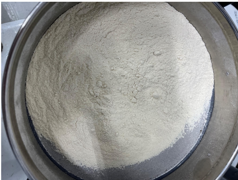
Figura 52. Evidencia fotográfica del tamizado mesh No .60 (laboratorio de operaciones unitarias, Universidad del Valle de Guatemala)
