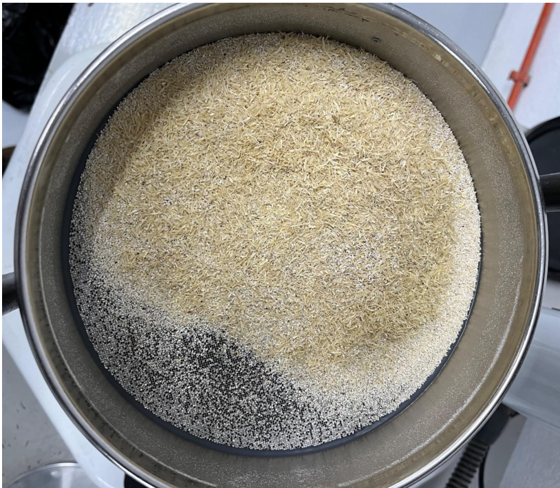
Figura 50. Evidencia fotográfica del tamizado mesh No. 30 (laboratorio de operaciones unitarias, Universidad del Valle de Guatemala)
