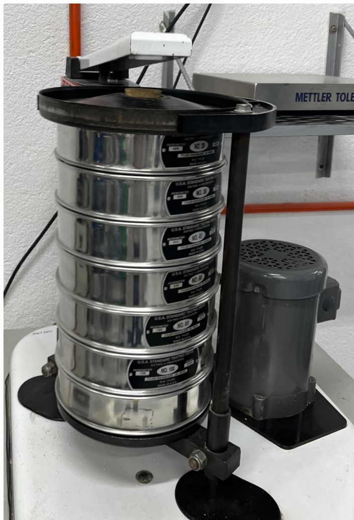
Figura 48. Evidencia fotográfica del tamizado (laboratorio de operaciones unitarias, Universidad del Valle de Guatemala)
