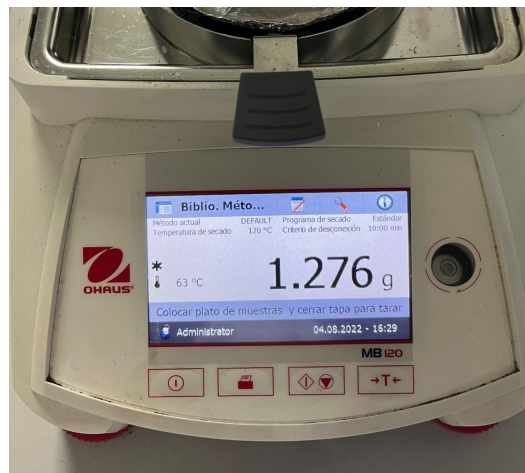
Figura 35. Evidencia fotográfica de las mediciones de humedad (laboratorio de operaciones unitarias, Universidad del Valle de Guatemala)
