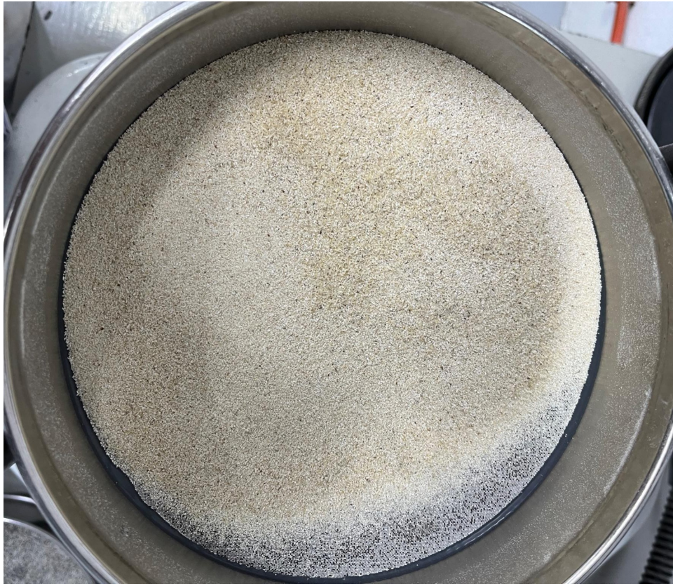
Figura 52. Evidencia fotográfica del tamizado mesh No .60 (laboratorio de operaciones unitarias, Universidad del Valle de Guatemala)
