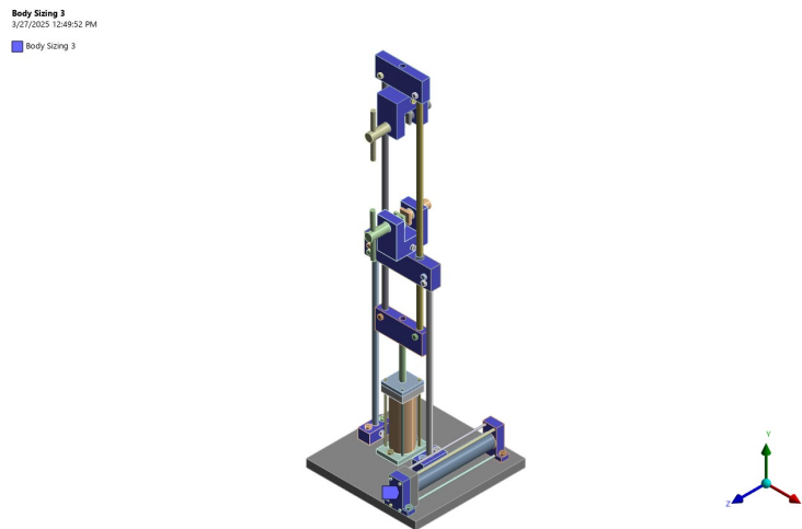
Figura 57. Piezas “Body Sizing” de 10 milímetro en color azul
