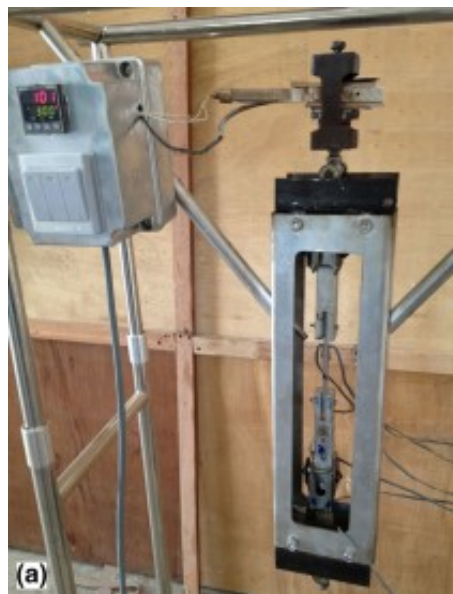
Figura 6. Máquina de ensayos de tensión para aluminio de la Universidad de Tecnología de Malasia
