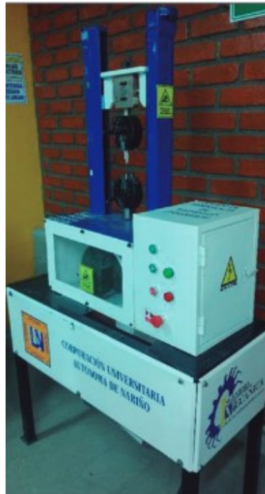
Nota. Obando, Sepúlveda, Piambac & Moran (2020). Desarrollo de una prensa para ensayos de tensión en polímeros.
