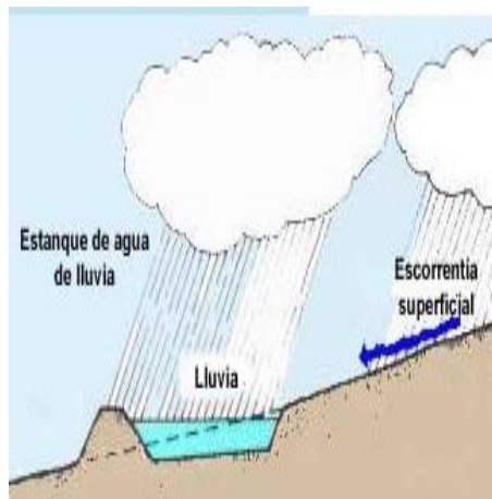
Figura 14: “Reservorio de agua de escorrentía superficial”
