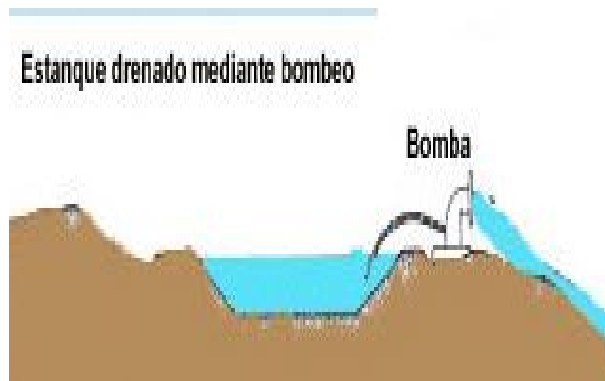
Figura 18: “Vaciado mediante bombeo drenable”
