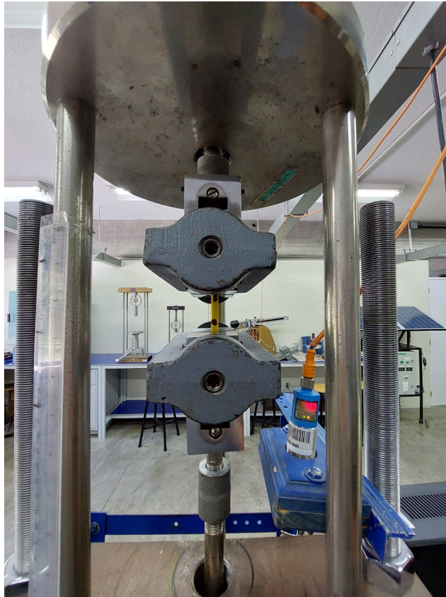
Figura 21: Configuración del equipo para realizar los ensayos a tensión
