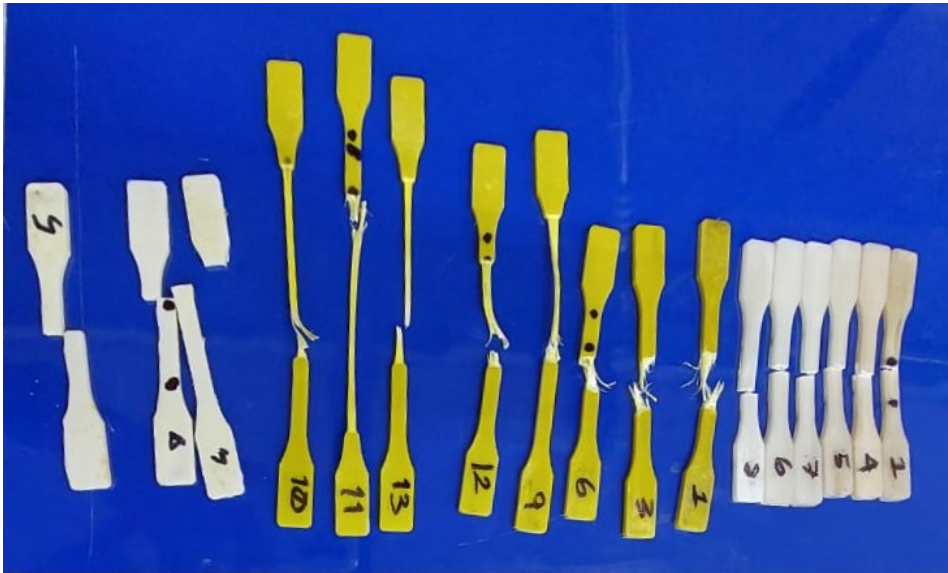
Figura 27: Probetas posterior a los ensayos realizados en orden de prueba (Orden izquierda a derecha: PHB, PP y HDPE)
