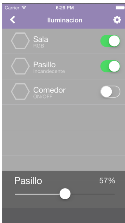
FIGURA NO. 39. CONTROL DE MÓDULO DE ILUMINACIÓN INCANDESCENTE
