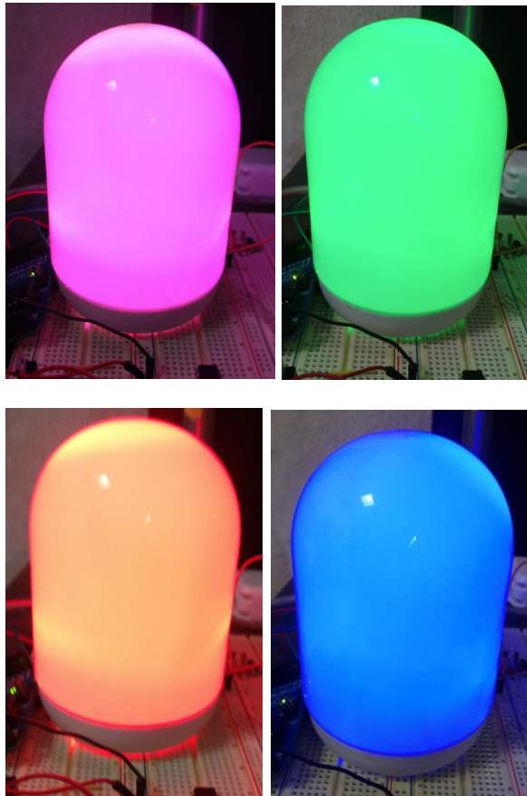
FIGURA NO. 104. DIFERENTES COLORES OBTENIDOS CON EL MÓDULO DE ILUMINACIÓN RGB.
