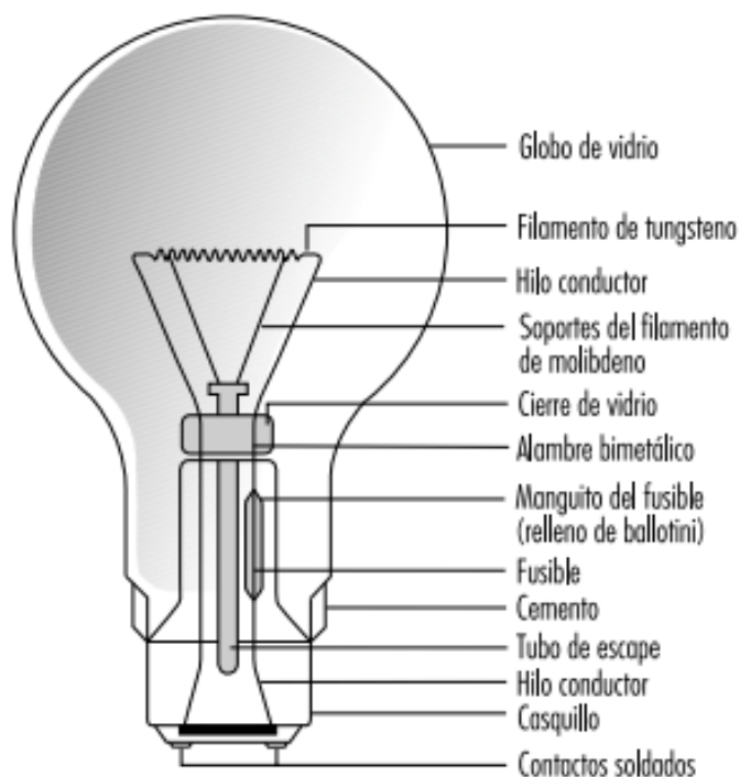
FIGURA NO. 21. COMPONENTE DE UNA LÁMPARA INCANDESCENTE
