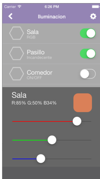
FIGURA NO. 38. CONTROL DE MÓDULO DE ILUMINACIÓN RGB
