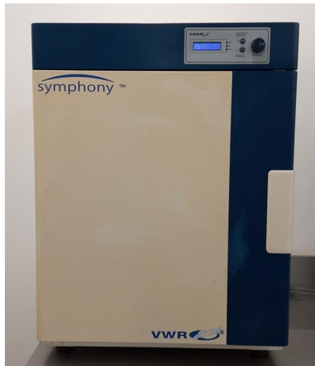
Figura 41. Horno de secado por convección marca VWR empleado para la experimentación
