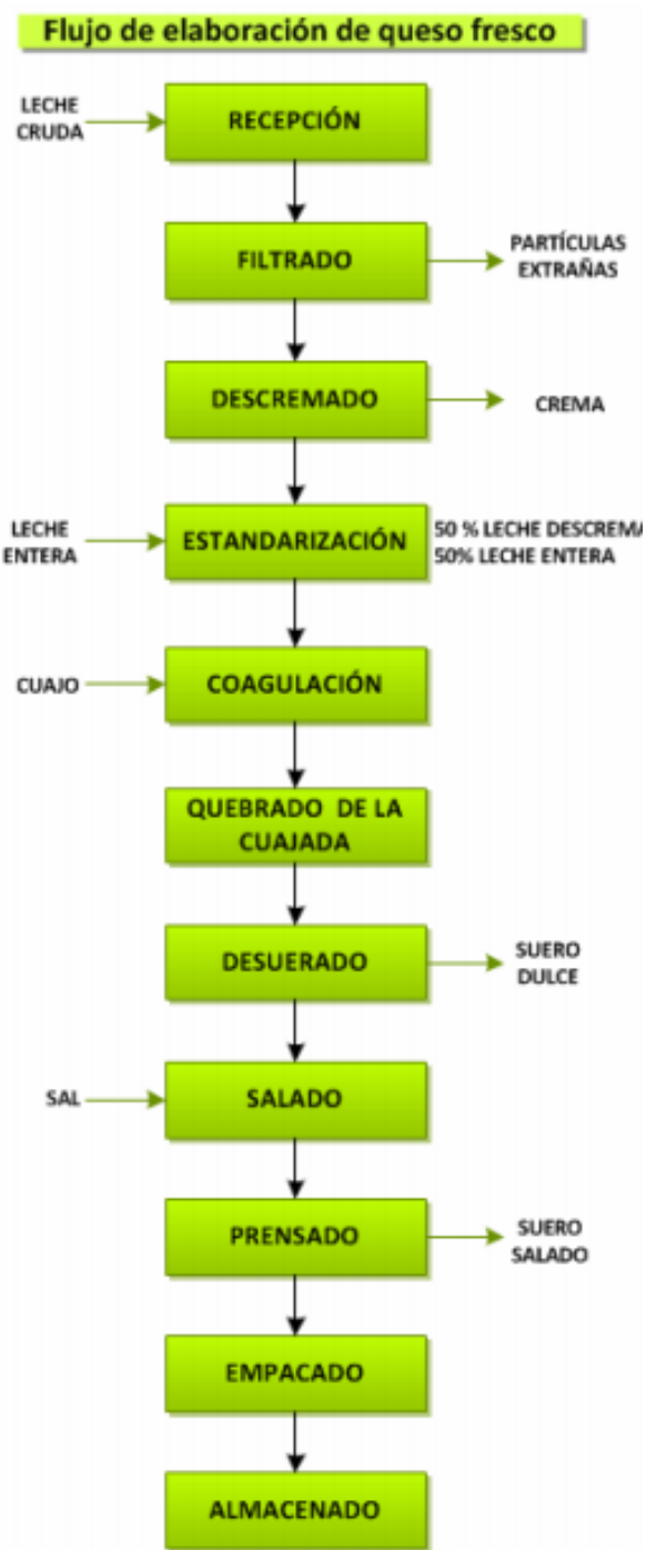
Figura 2. Diagrama general del proceso de producción de queso fresco (FAO, 2011)
