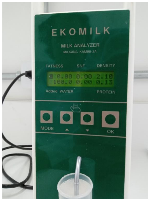
Figura 39. Ekomilk marca BULTEH empleado para la caracterización del lactosuero
