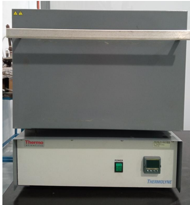
Figura 40. Mufla marca Thermo Scientific empleada para la caracterización del lactosuero
