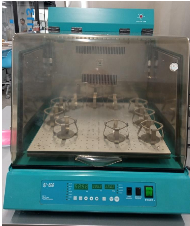
Figura 43. Agitadora marca Lab. Companion empleada para la fermentación de la solución de lactosuero al 10 % m /v
