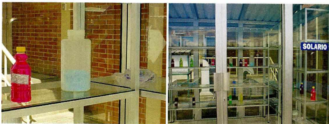
Figura No. 26: Añejamiento de las muestras producidas con radiación solar extrema (exposición a la radiación ultravioleta)
