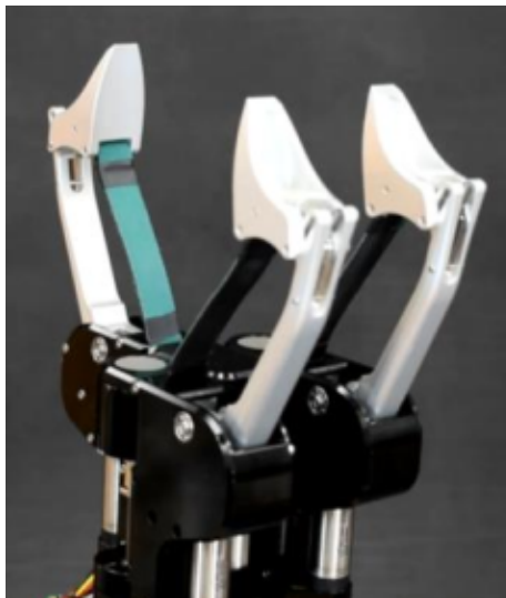
Figura 5. Gripper BLT con 3 dedos independientes [4]
