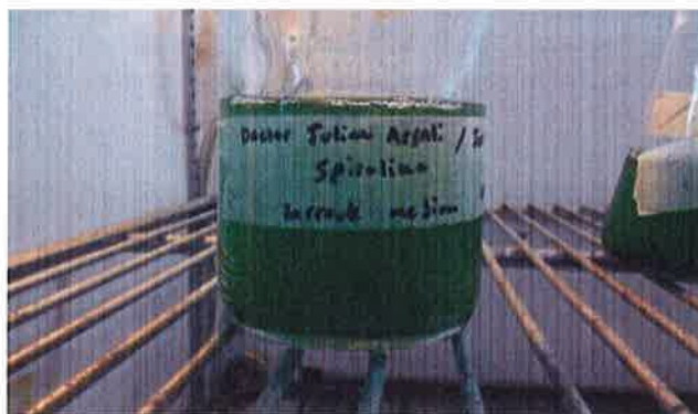
Figura 7. Crecimiento visible y ausencia de aglomeraciones en el medio de Zarrouk a los 11 días con iluminación homogénea y filtración de los medios cada 5 días
