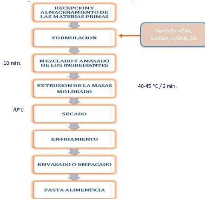
Figura 2. Proceso de elaboración de pastas alimenticias
