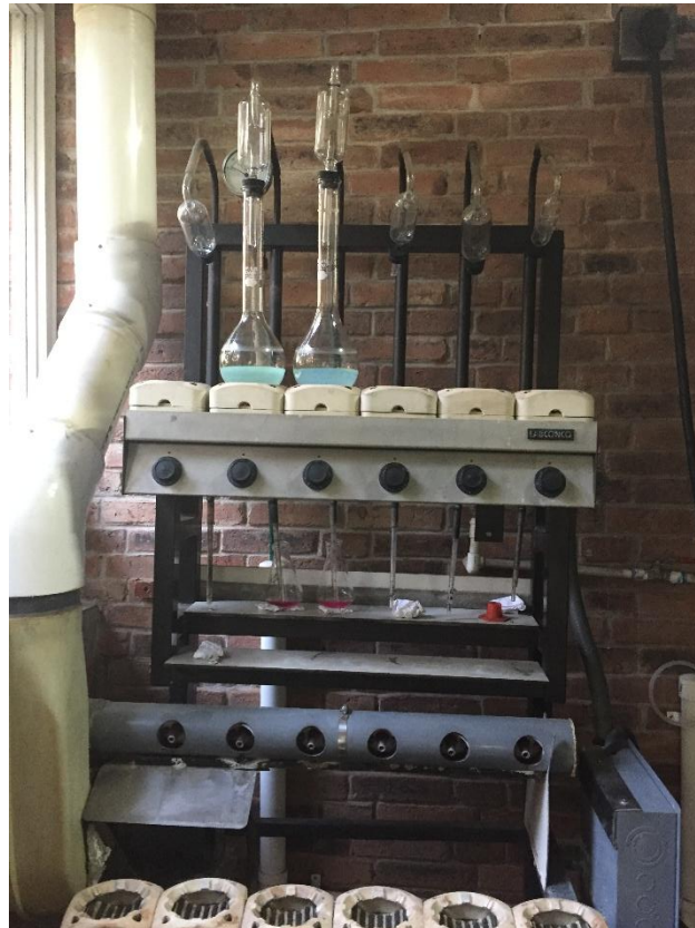
Figura 19. Muestras en el equipo Kjeldahl para el análisis de proteína.
