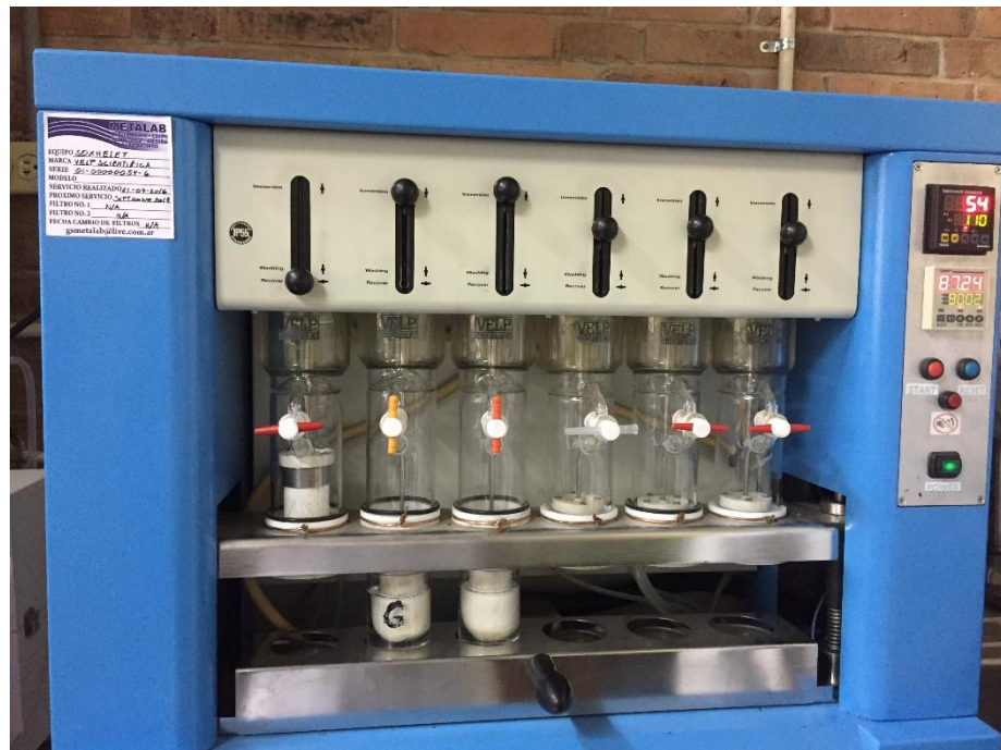
Figura 17. Muestras en el equipo Soxhlet para el análisis de grasas.
