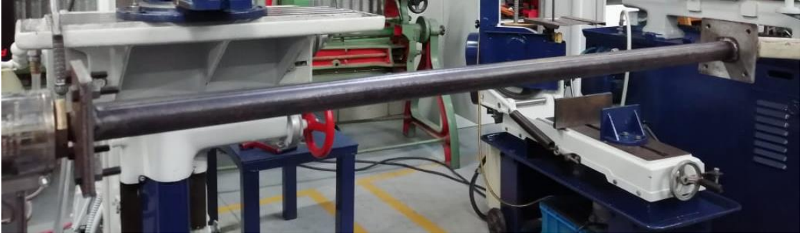
Ilustración 12. Ensamblaje del perfil de trabajo a la matriz de extrusión.
