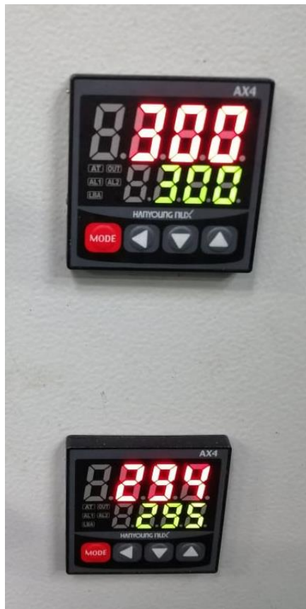
Ilustración 5. Temperatura de operación (300°C)
