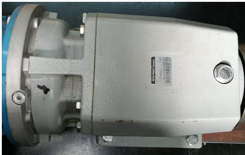
Figura 86. Caja reductora Bonfiglioli , relación 31.4:1
