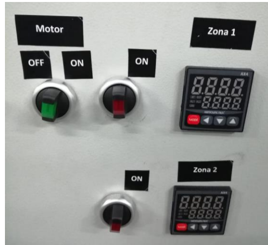
Ilustración 4. Distribución de switches
