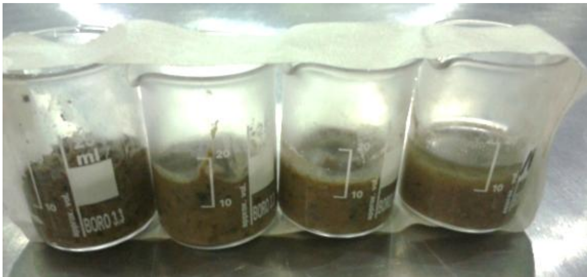
Figura No. 94 Imagen de la prueba para determinar la proporción D/Ag. De izquierda a derecha, relación de: 0, 0.5, 1 y 2.
