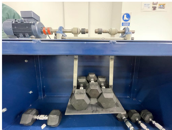
Figura 87: Resultado de soporte de peso por sistema de carga y transmisión de potencia
