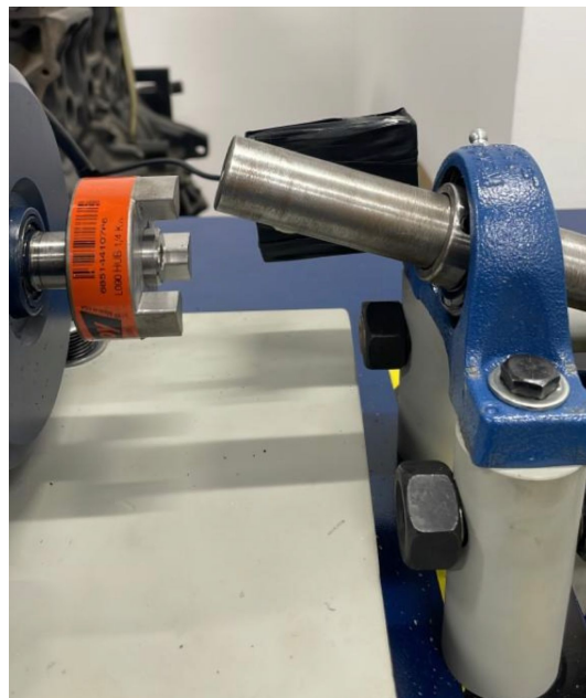
Figura 89: Restricción de acople al eje de transmisión de potencia
