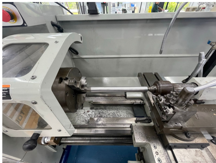
Figura 63: Desbastado de barra para llegar a 25 mm
