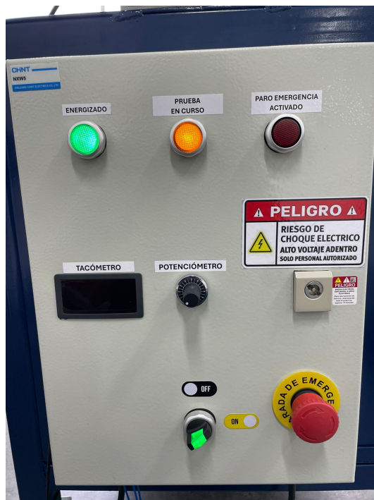
Figura 85: Resultado de potenciómetro, interruptor (ON) y luz piloto amarilla
