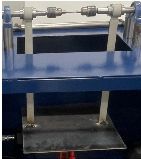
Figura 80: Sistema de carga montado a banco de máquina de fatiga
