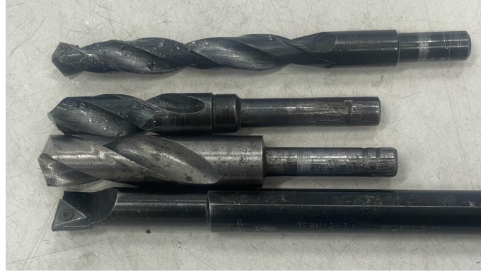
Figura 76: Brocas y porta herramienta utilizado para crear los diámetros del cargador
