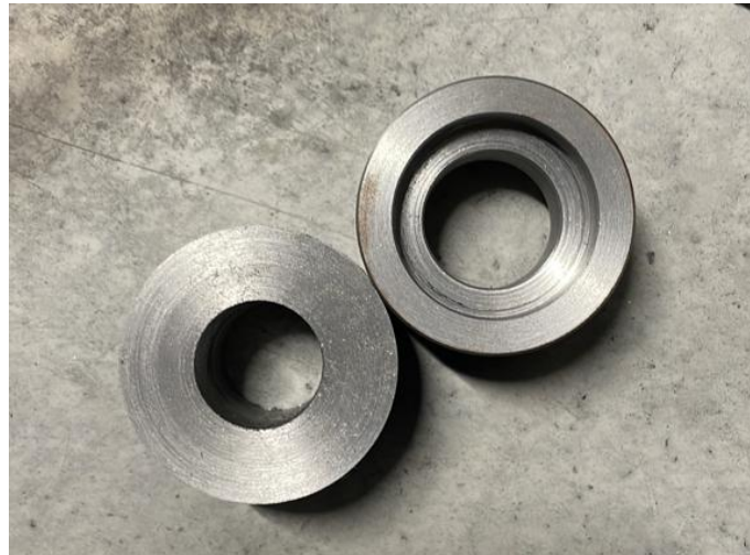
Figura 77: Maquinado de cargadores
