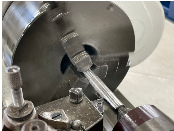
Figura 70: Rectificación de diámetro de probetas
