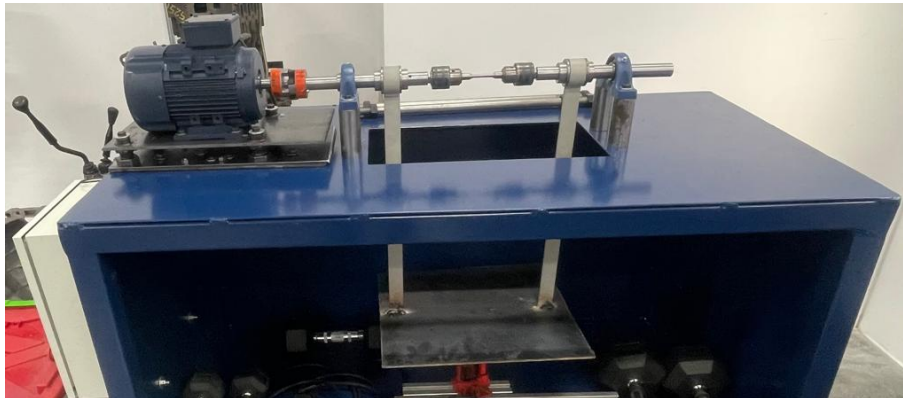
Figura 83: Montaje de máquina de fatiga al banco
