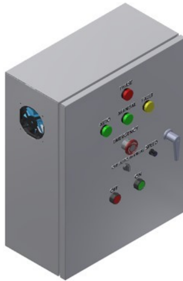
Figura 14: Prediseño de caja eléctrica
