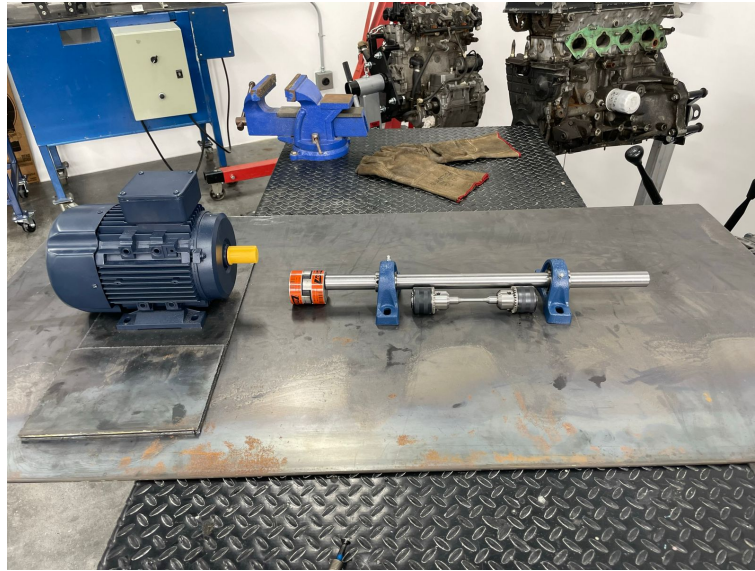
Figura 64: Ensayo de eje maquinado en chumaceras
