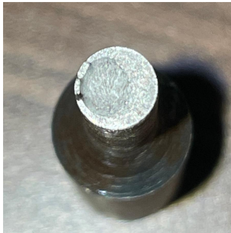
Figura 95: Marca de playa en primera mitad de la probeta
