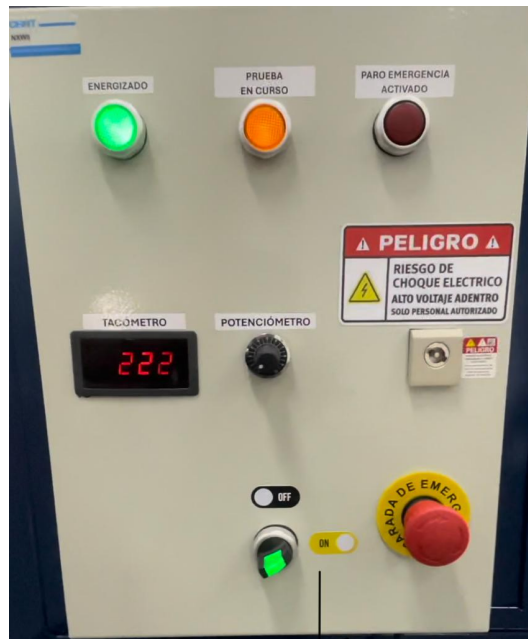
Figura 86: Resultado de lectura de revoluciones por minuto con tacómetro
