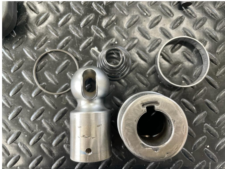
Figura 91: Manufactura de nuevo acople utilizando la junta universal
