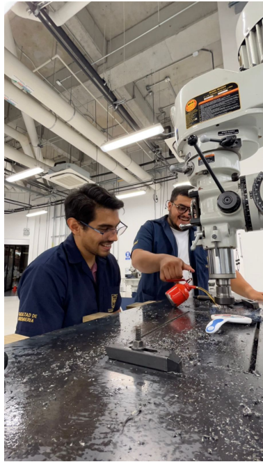
Figura 58: Realización de boquete a placa superior de banco
