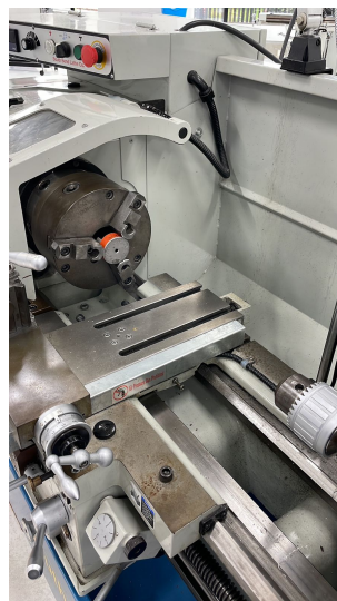
Figura 69: Posicionamiento de acople en torno para maquinado
