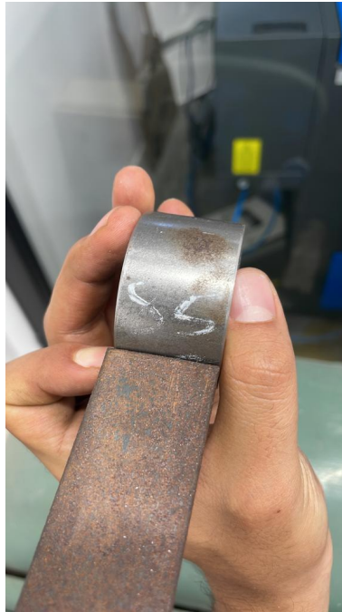
Figura 78: Verificación del ancho de hembra con ancho del cargador
