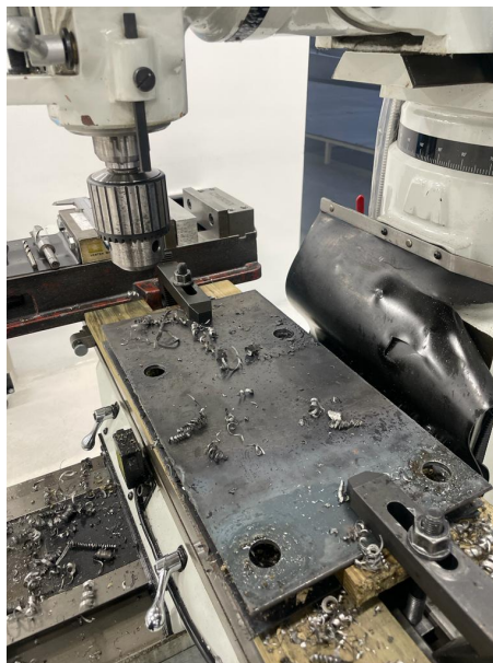
Figura 81: Maquinado de placas de sistema de nivelación
