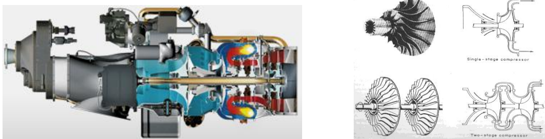
Ilustración 17. Motor Pratt & Whitney PW100 (18)
