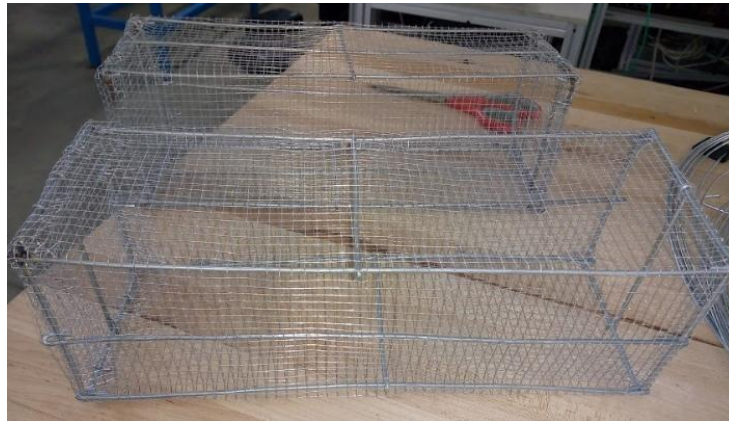
Figura 7 Estructuras con alambre y malla de tipo galvanizado
