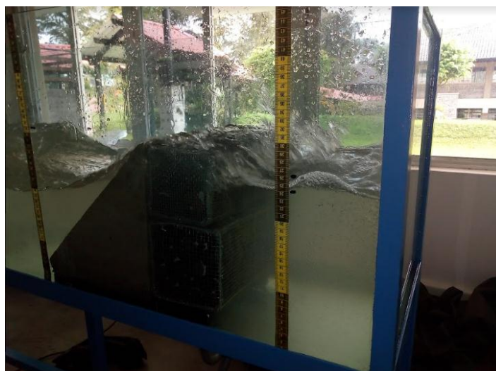
Figura 17 Contrafuerte inclinado en oleaje rápido
