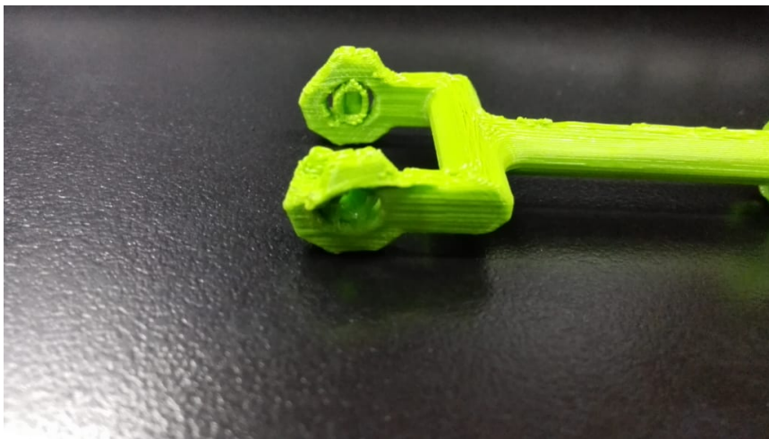
Figura 41: Fallo en la manufactura de piezas para la junta
