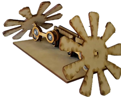
Figura 25: Prototipo 2 implementado con ruedas con ángulo
