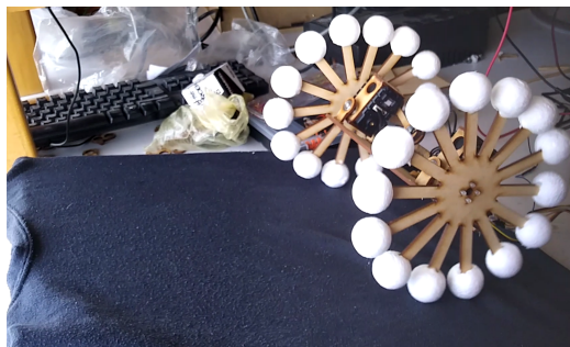
Figura 32: Prototipo 3 subiendo una pendiente con las ruedas en posición vertical
