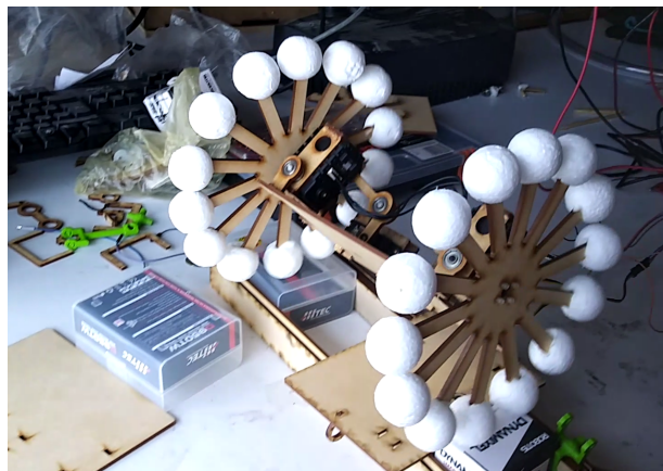
Figura 37: Prototipo 3 desplazándose sobre obstáculos
