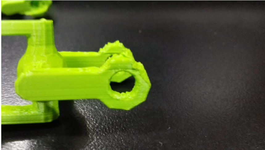
Figura 40: Dificultades en la manufactura de piezas para la junta
