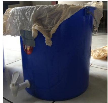
Figura 103. Sistema para filtración de lixiviados
