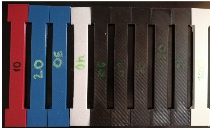
Figura 29: Probetas impresas utilizadas para el ensayo a tensión.
