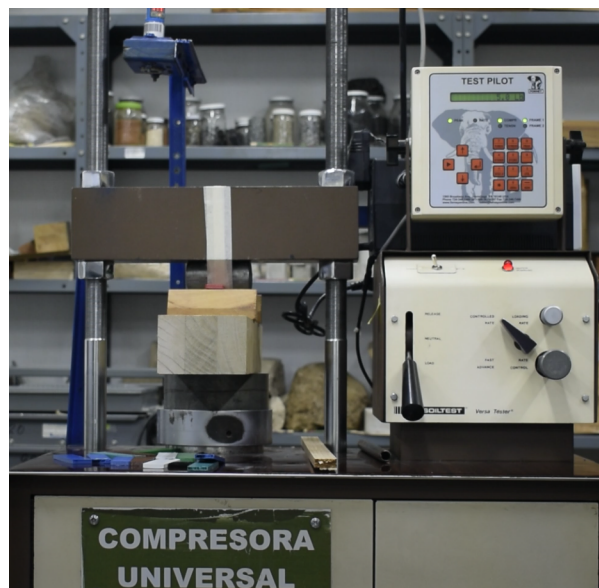
Figura 33: Equipo y configuración utilizada para el ensayo a flexión visto lateralmente.
