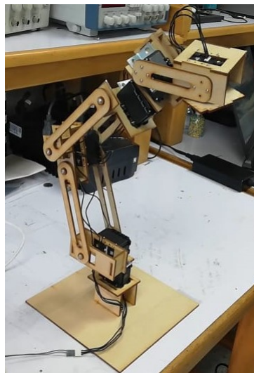
Figura 22: Ensamble físico del segundo prototipo del brazo robótico.
