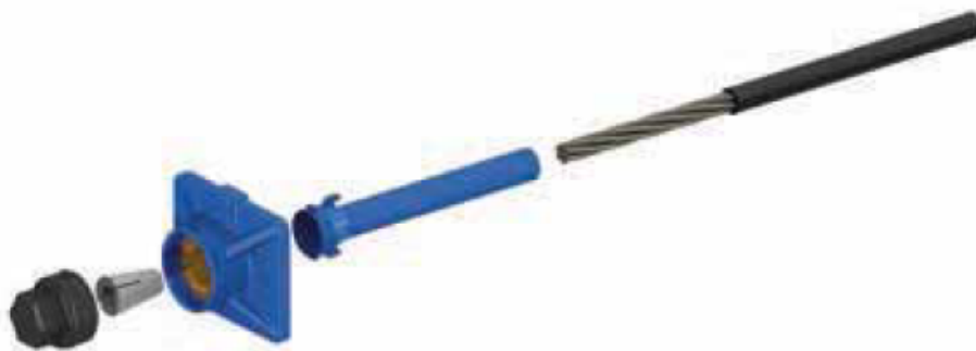
Figura 30: Sistema de monoTorones: VSL no adheridos para losas postensadas [21]
