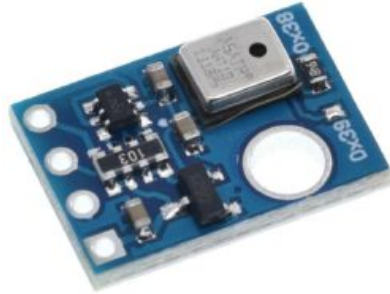
Figura 32: Sensor de temperatura y humedad relativa - AHT10
