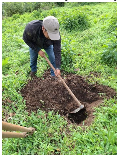
Excavación de calicata
