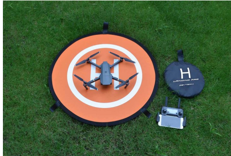
Figura 32: Pad de aterrizaje para drones
