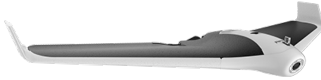
Figura 7: Drone de tipo ala delta
