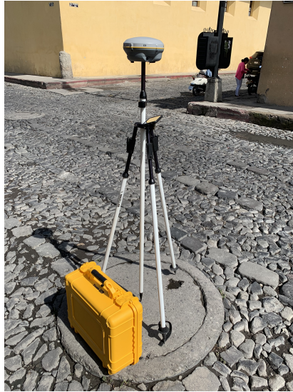
Figura 39: Medición de los puntos de control
