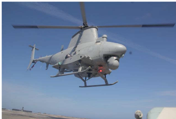
Figura 8: Drone de un solo rotor y rotor de cola
