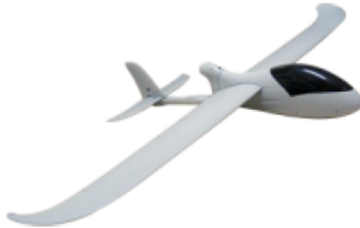
Figura 5: Drone de ala fija media
