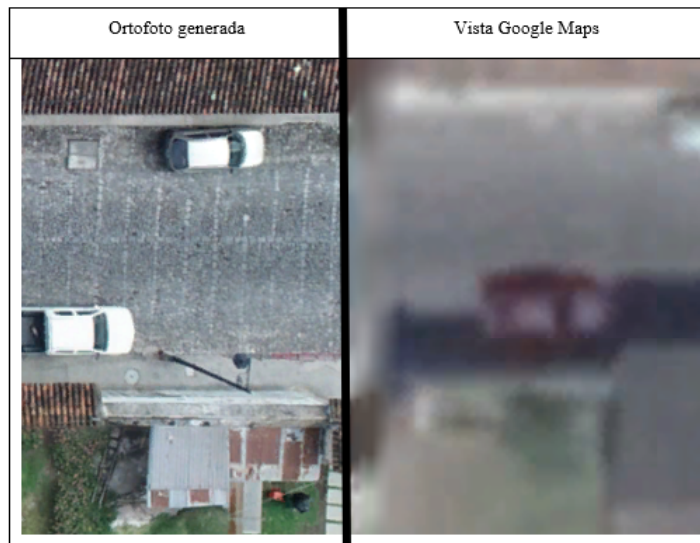
Figura 84: Comparación de resolución de fotos a una altura de 70 metros
