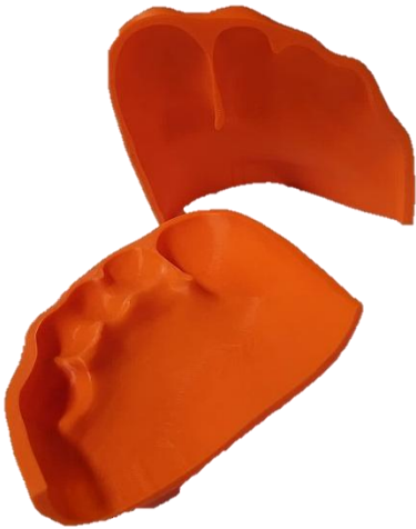
Figura 35. Impresión 3D plantilla abierta
