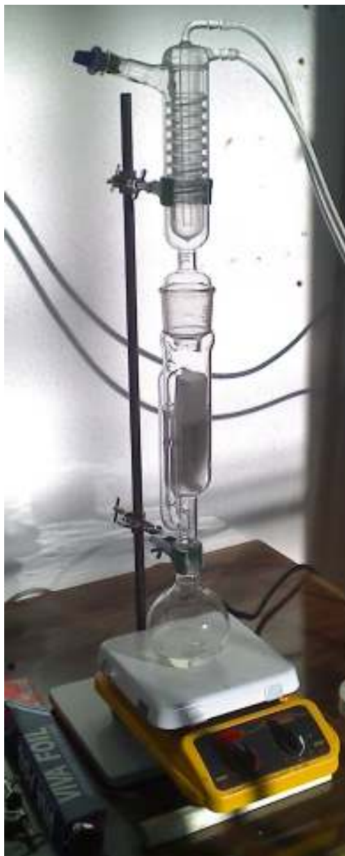
Fotografía. No 1 Equipo de extracción soxleth utilizado
