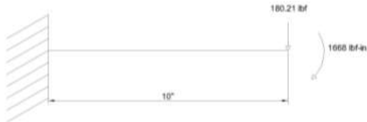
Ilustración 39: Diagrama de fuerzas y momentos
