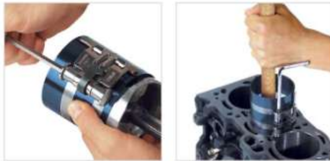
Ilustración 33: Instalación de cilindros
