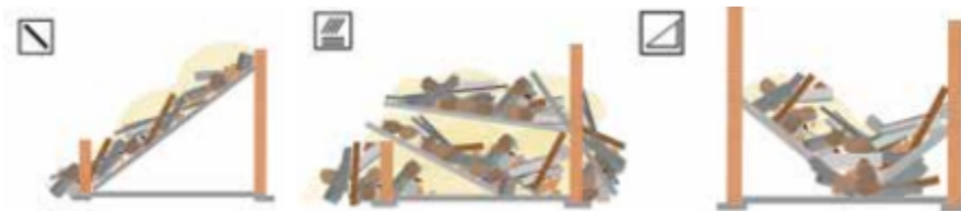
Figura 1: Tipos de estructuras colapsadas, de izquierda a derecha: oblicuo, derrumbe total, y marquesina
