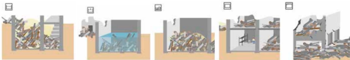
Figura 2: Tipos de estructuras colapsadas, de izquierda a derecha: espacio relleno, espacio inundado-embarrado, espacio estratificado, tapón de escombros y local impactado.
