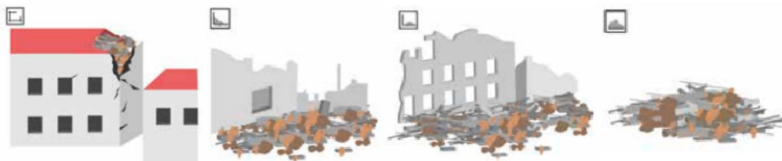
Figura 3: Tipos de estructuras colapsadas, de izquierda a derecha: nido de golondrinas, escombros adosados al exterior, escombros dispersos en el exterior, derrumbamiento de cono de escombros.
