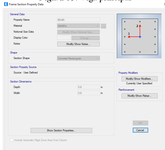
Figura 16. Columna de borde y central
