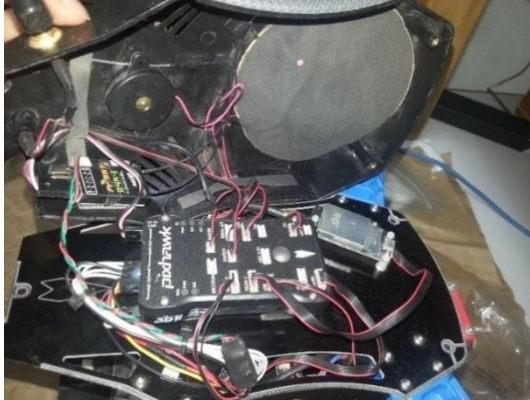
Figura 49. Distribución componentes UAV
