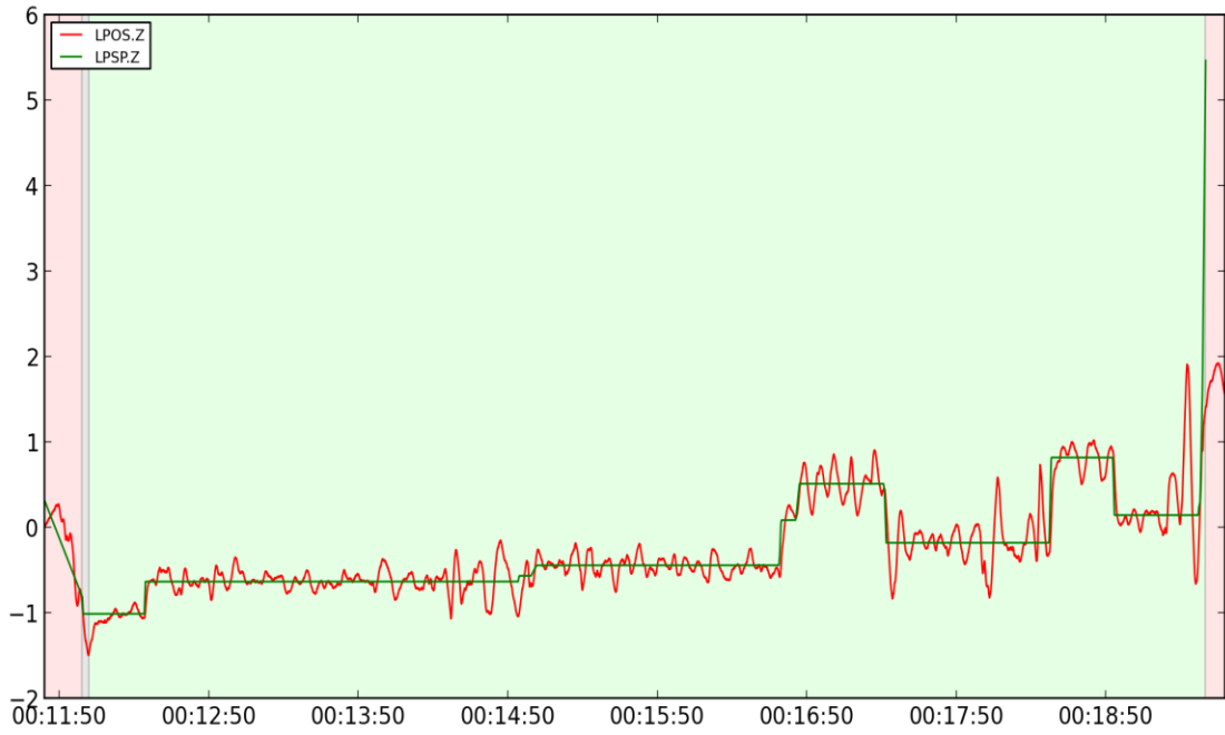
Figura 70. Respuesta del sistema control vertical previo sintonización
