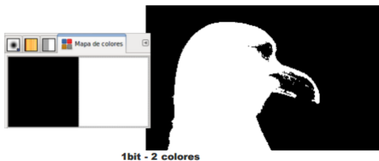
Figura 32. Imagen con profundidad de color igual a 1 bit, i.e. 2 niveles de representación. A la izquierda se encuentran los distintos niveles de representación y a la derecha se tiene la imagen resultante
