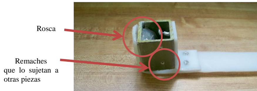
Ilustración 105 Piezas unidas por remaches
