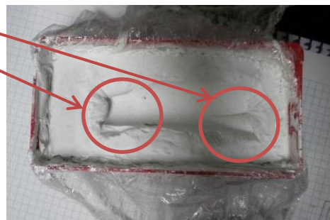
Ilustración 111 Molde negativo de prueba de fibra de vidrio y recipiente preparado
