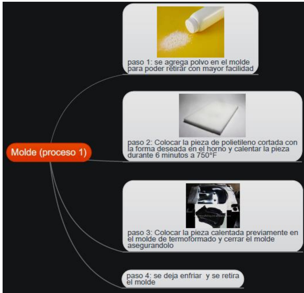
Ilustración 176 Proceso de prueba de molde de termoformado
