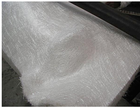
Ilustración 109 Colocación de fibra sobre la configuración
