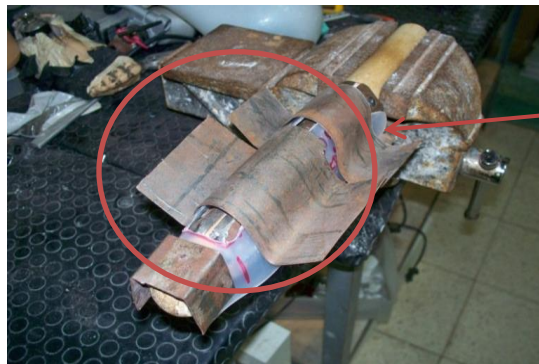
Ilustración 102 Conformado de pieza plástica con moldes rústicos
