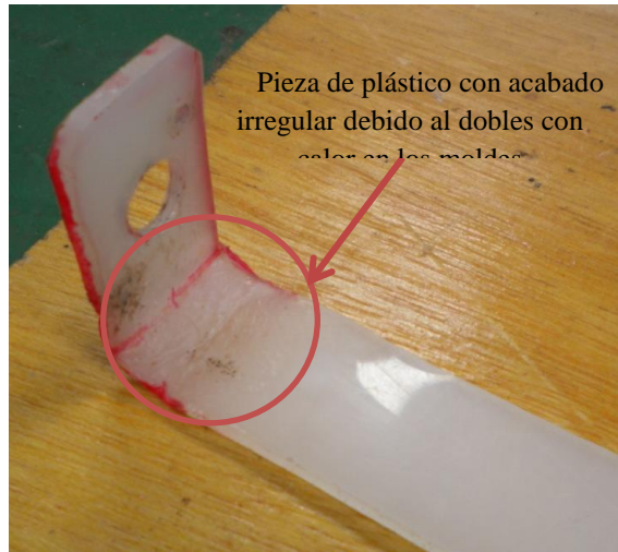
Ilustración 98 Componente 3 al doblarse con el proceso actual presenta irregularidad
