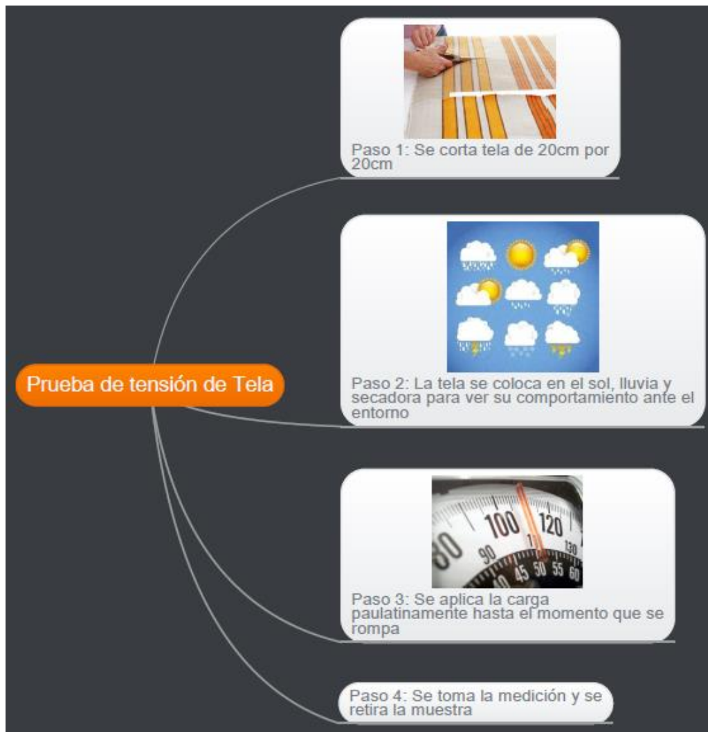
Ilustración 179 Proceso para prueba de telas
