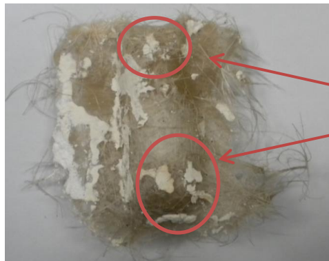
Ilustración 113 Segunda prueba con 2 capas de fibra de vidrio
