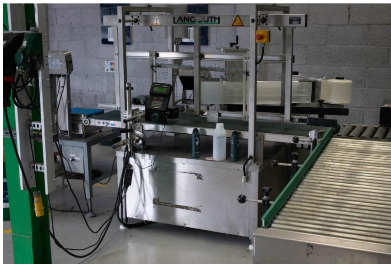
Anexo 15 Etiquetadora de cajas
