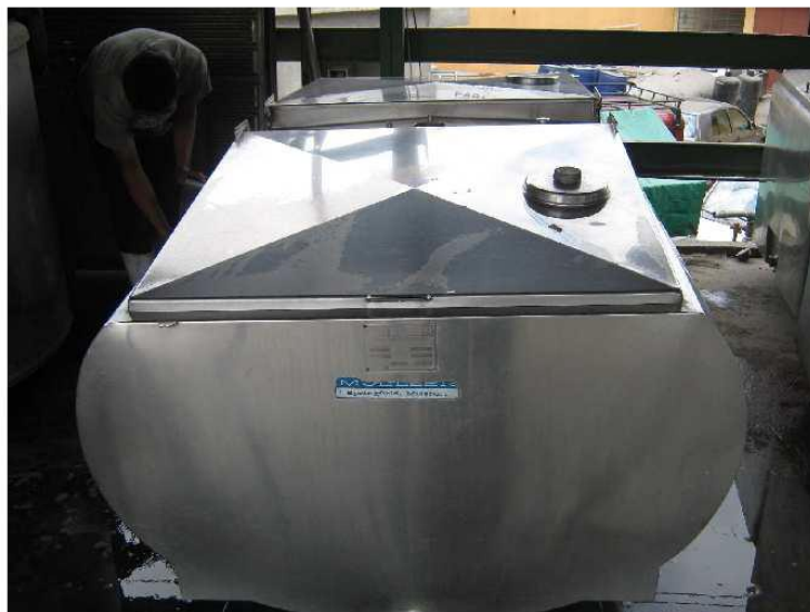
Figura No. 5. Tanque de enfriamiento.
