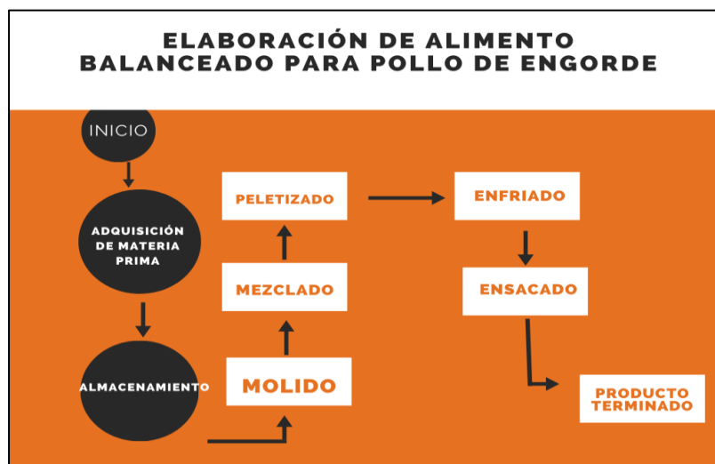
Figura 8 Proceso de peletizado de alimento balanceado para aves
