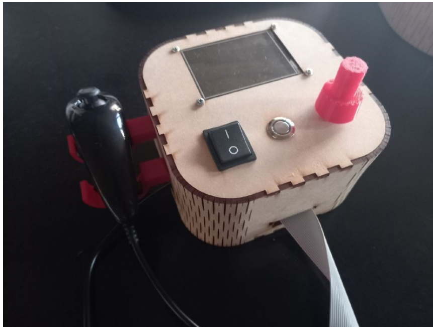
Figura 53: Control de mandos prototipo 4 vista isométrica
