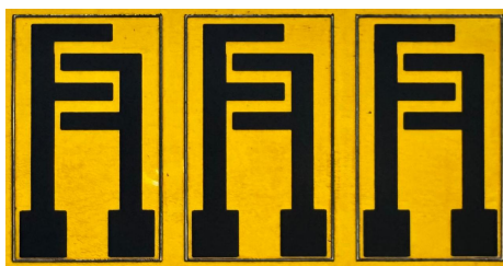
Figura 18. Electrodos de grafeno sobre sustrato de Kapton fabricados mediante grabado láser
