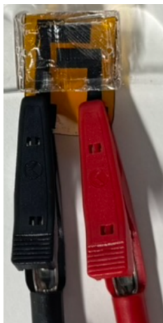
Figura 17. Sistema microfluídico conectado a la placa EmStat Pico para mediciones EIS
