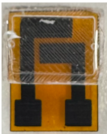
Figura 24. Unión del sistema microfluídico con electrodo de grafeno
